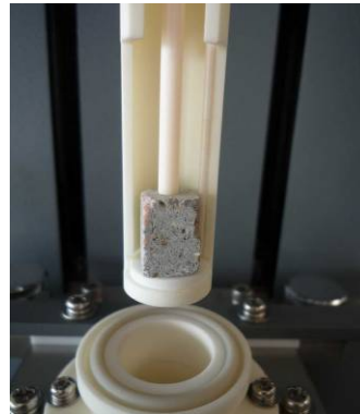
圖 7 TMA 試樣安裝示意圖 【本研究拍攝】
