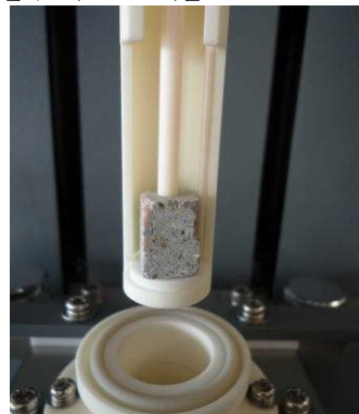
圖 7 TMA 試樣安裝示意圖 【本研究拍攝】
