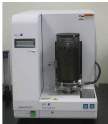
圖3 熱示差掃描分析儀 (DSC)【本研究拍攝】
