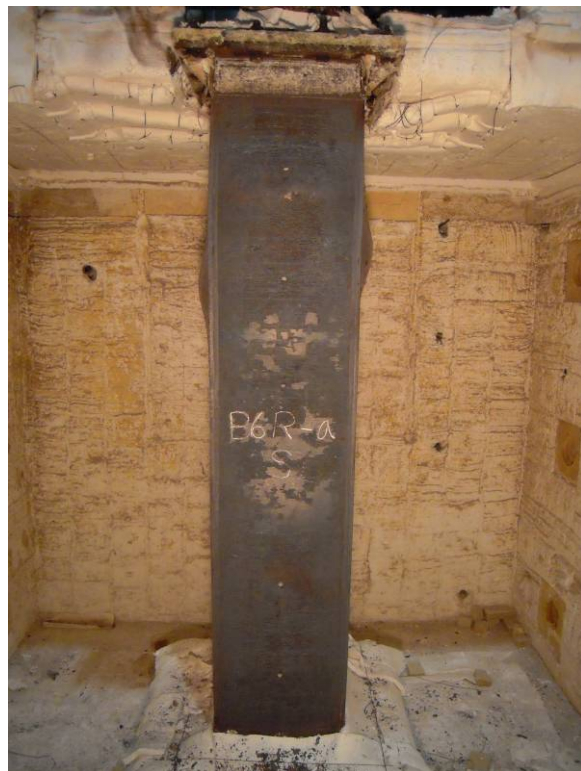
照片1：實驗前試體安裝(I)
