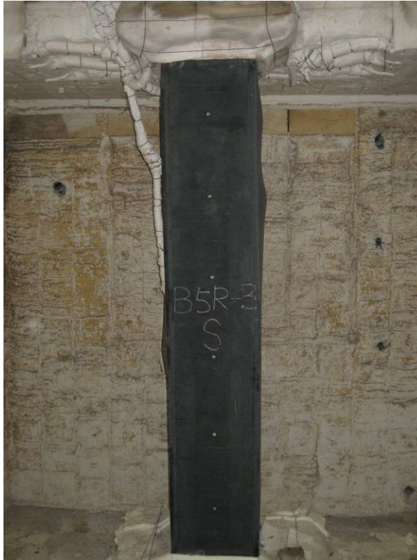
照片3：試驗後試體破壞情況(II)
