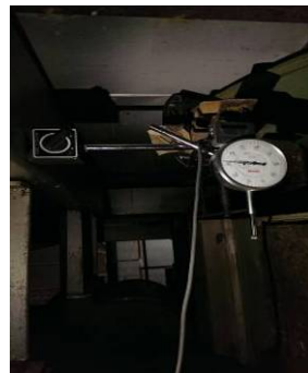
圖7 壓縮量測點位置圖
