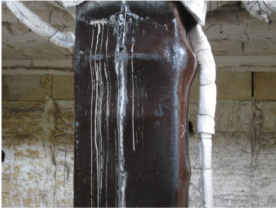
照片3：試驗後試體破壞情況(II)
