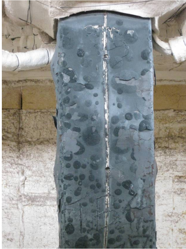
照片3：試驗後試體破壞情況(II)
