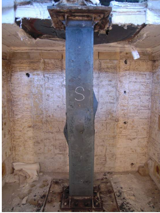
照片3：試驗後試體破壞情況(I)
