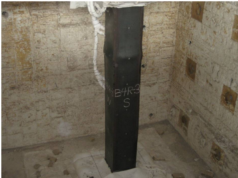
照片4：試驗後試體破壞情況(IV)
