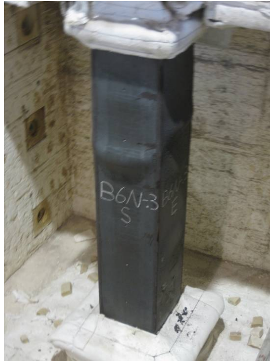
照片3：試驗後試體破壞情況(I)
