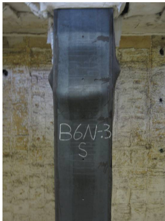
照片4：試驗後試體破壞情況(II)
