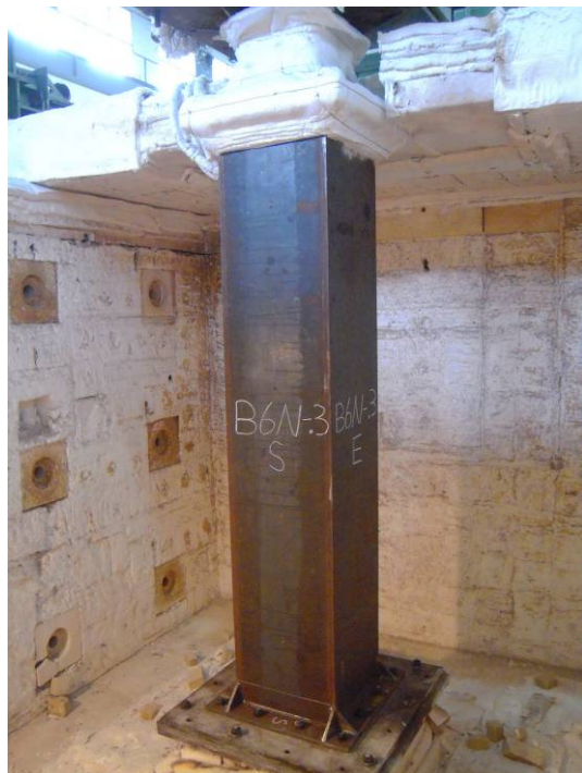
照片2：實驗前試體安裝(II)
