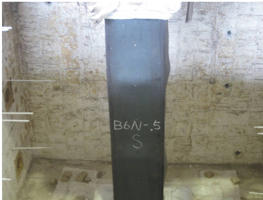
照片3：試驗後試體破壞情況(I)
