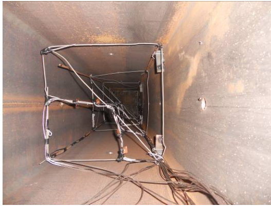
照片1：試體斷面內溫度點布設
