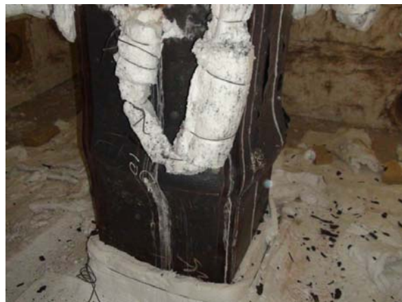
圖 25 試體 PP1 之局部挫屈情形
