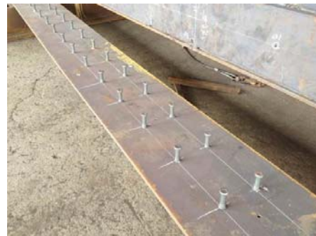
圖 3 箱型鋼柱之剪力釘鉚製
