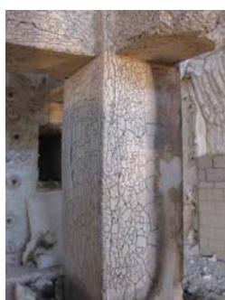
圖 6 NC3 試體在高溫試驗後現象
