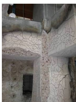
圖 7 SCC3 試體在高溫試驗後現象
