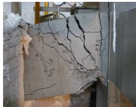
圖 18 SCC1 試體之破壞模式
