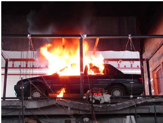
(c) 後車窗破裂
