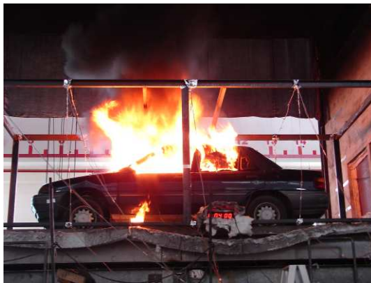
(c) 後車窗破裂
