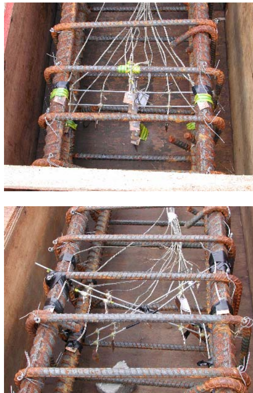
圖 3.6 熱電偶配置圖
