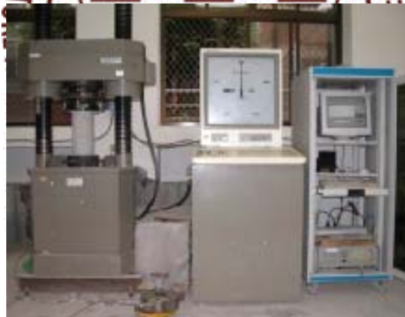
照片 3.1 混凝土抗壓試驗
