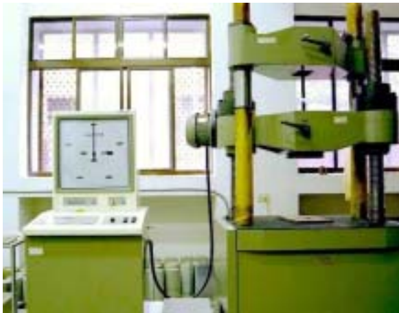
照片 3.2 鋼筋抗拉試驗
