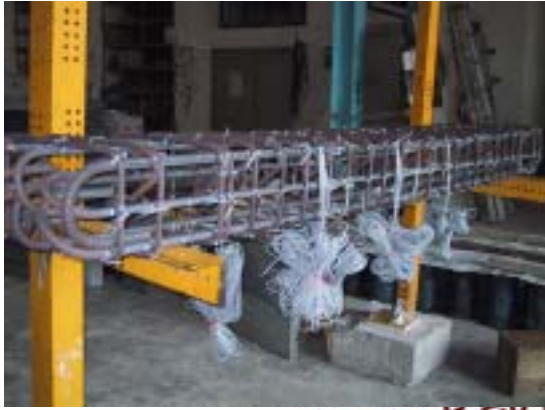
照片 3.5 鋼筋籠完成
