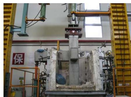
圖 8 梁柱試體安裝於加熱爐內
