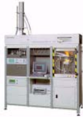
圖 1 圓錐量熱儀裝置實體圖 圖 2 構造示意圖(節錄自 ISO 5660-1(1993)中插圖)
