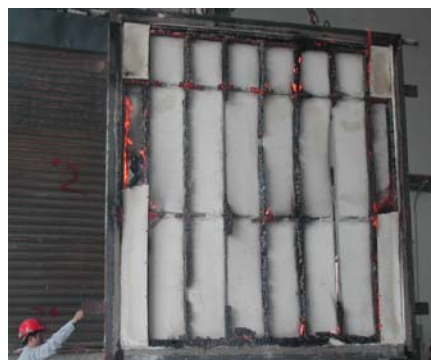
覆蓋板材料燃燒後崩落，岩棉失去支撐也掉落
