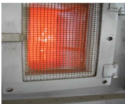
從加熱爐觀測窗觀察受火面覆蓋板崩落木構架整體燃燒
