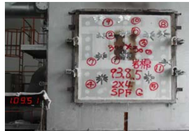
石膏板覆蓋板材料表面為紙板產生炭化的黑色
