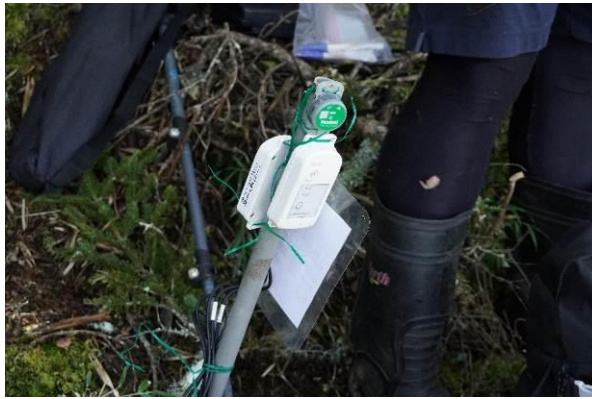
每大區架設一組 data log 進行監測。
