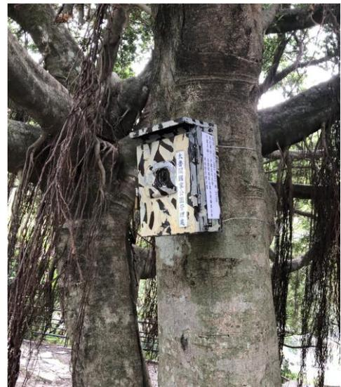
圖 5. 監測攝影機保護鐵箱設置現況照片
