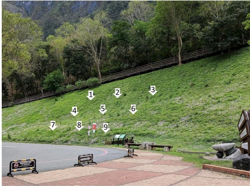
圖一、布洛灣台地斜坡土壤採樣地點。1、2、3：斜坡上部。4、5、6：斜坡中央。7、8、9：斜坡下端。此九個採樣點土壤分別取 500 g 每三個混合均勻為上、中、下三個樣本，再行送驗。
