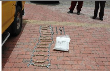
加 V 型 (破冰齒) 雪鏈要小心不要將突出部分裝反以免刺破輪胎，突出部分應向上不要接觸到輪胎。
