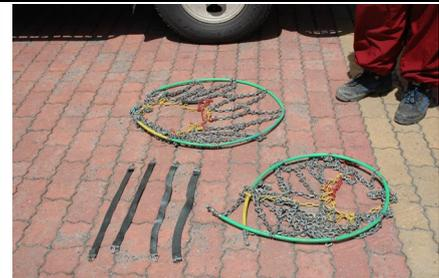
快扣型需注意鏈條太細容易斷裂，建議購買較粗之鏈條。**務必利用彈性繩索將雪鏈加強固定**，以免脫落。
