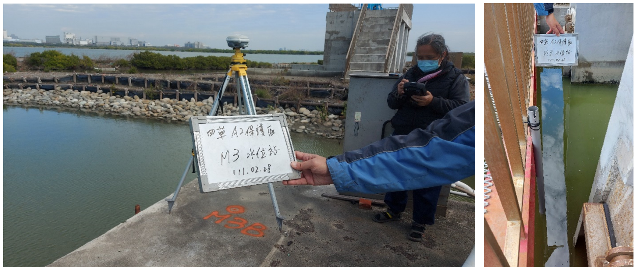
圖 2-3.8 M3 測站高程施測圖
