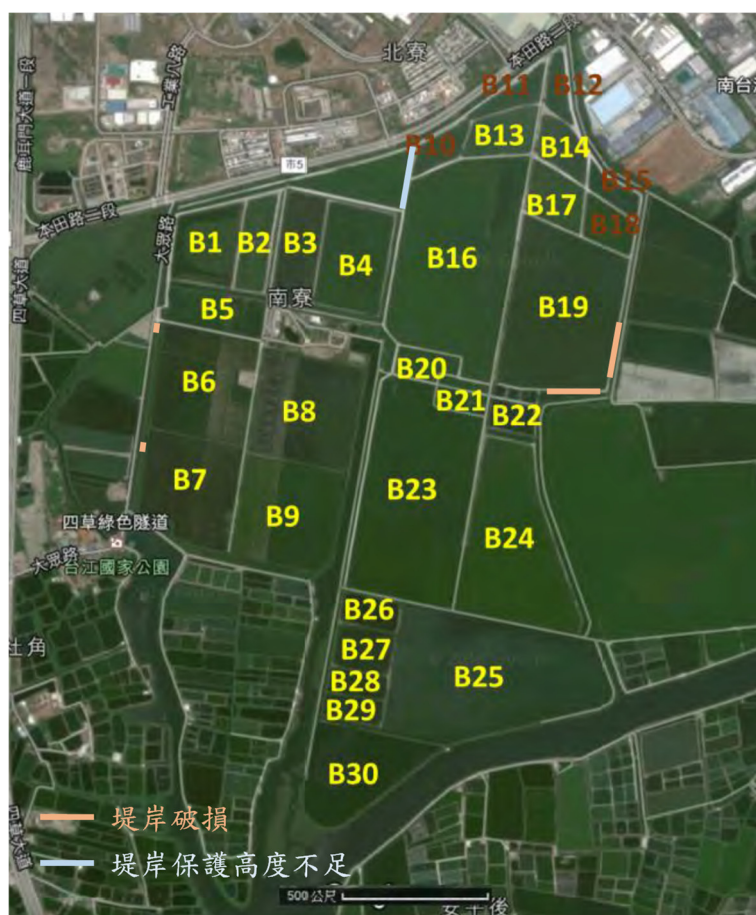
圖 2-2.13 圳路堤岸破損位置示意圖
