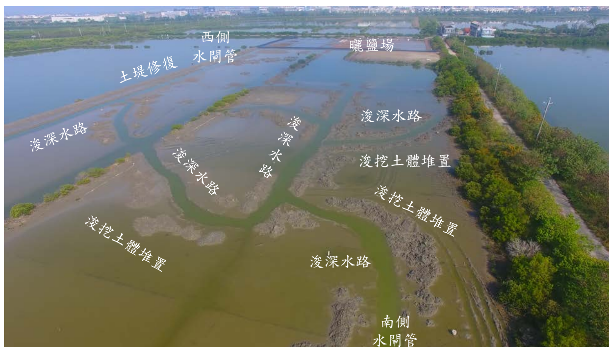
圖 2-2.6 試驗示範區水閘管布設圖
