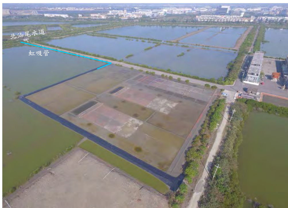
圖 5-2.5 虹吸引水管線布設示意圖
