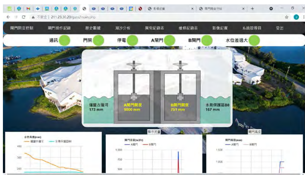
圖 2-3.5 B8 樣區東側防潮閘智慧雲端操控作業系統畫面圖
