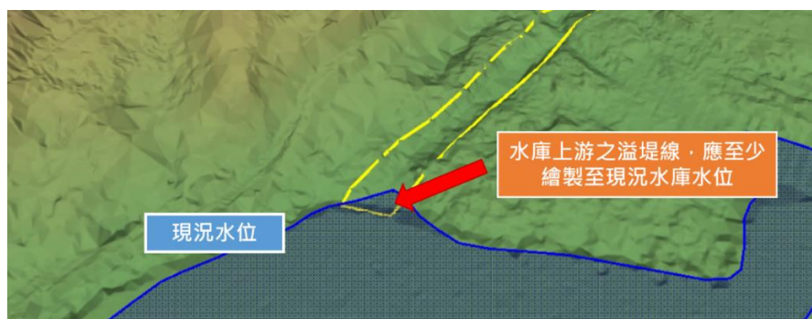
圖 3-3.12 水庫上游溢堤線繪製原則
