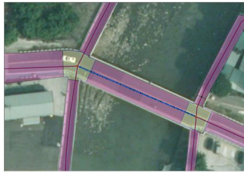
(a)橋梁結構前後節點以路口方式建置
