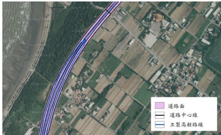
圖 2-54 使用立體製圖高程資料獲取中線高程範例
