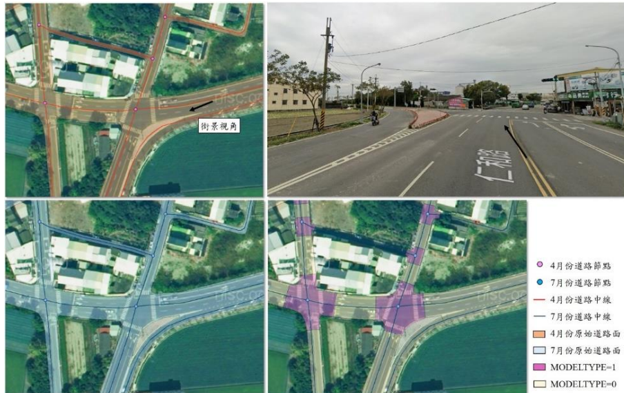
圖 2-40 電子地圖圖形錯誤案例
