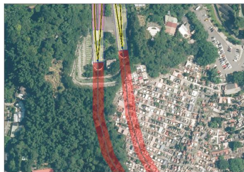
(c)隧道結構出入口以路口方式建置
