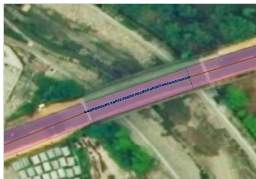
(b)直接切分於橋梁結構前後節點上
