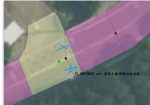
圖 2-19 將橋梁點包含在已切分路口內
