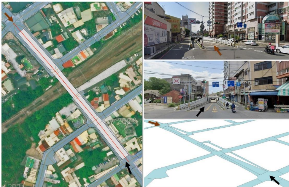
圖 2-55 本案地下道順接二端路面高程案例
