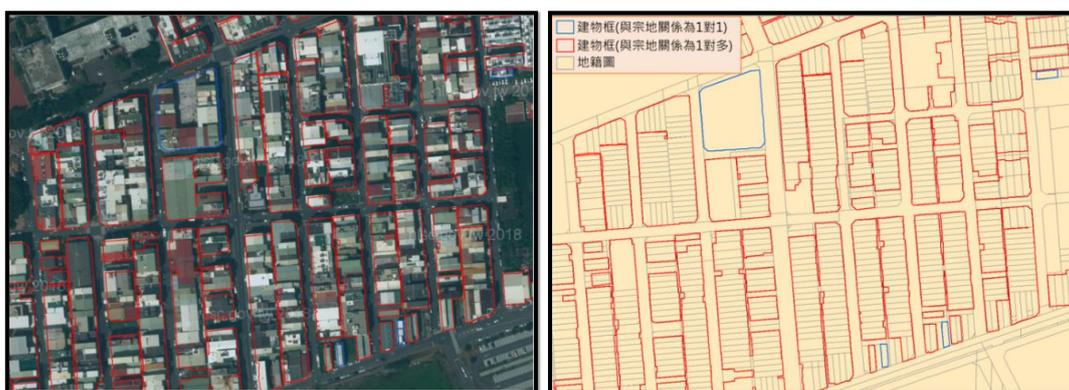
圖 2-72 建物框與地籍圖及正射影像套疊示意圖
