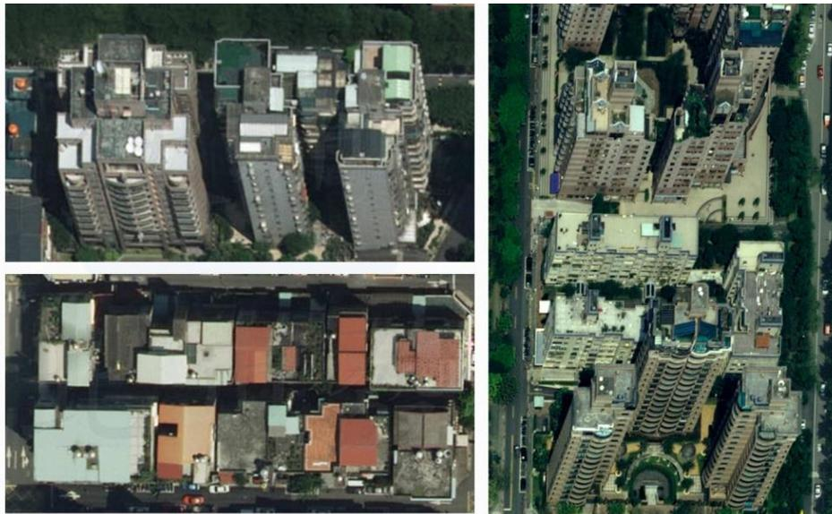
圖 2.22 正射影像建物傾斜狀況
