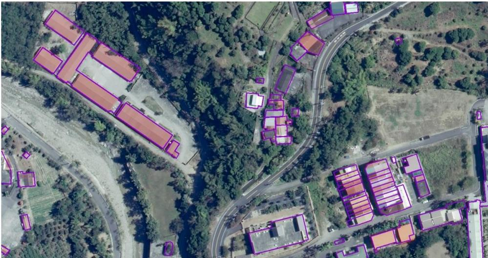
圖 3-19 建物框利用共線式投影平面坐標並與原始航拍套合分析(郊區)
