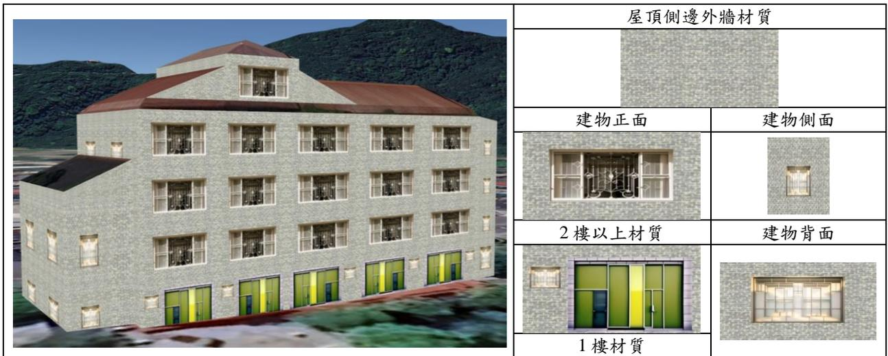
圖 2-101 LOD2 近似化建物模型使用貼圖材質範例
