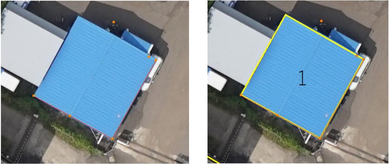
圖 3-17、現況點位搭配 UAS 影像輔助建物更新
