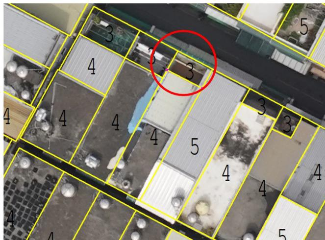
圖 4-9、UAS 影像量測並分割建物坵塊
