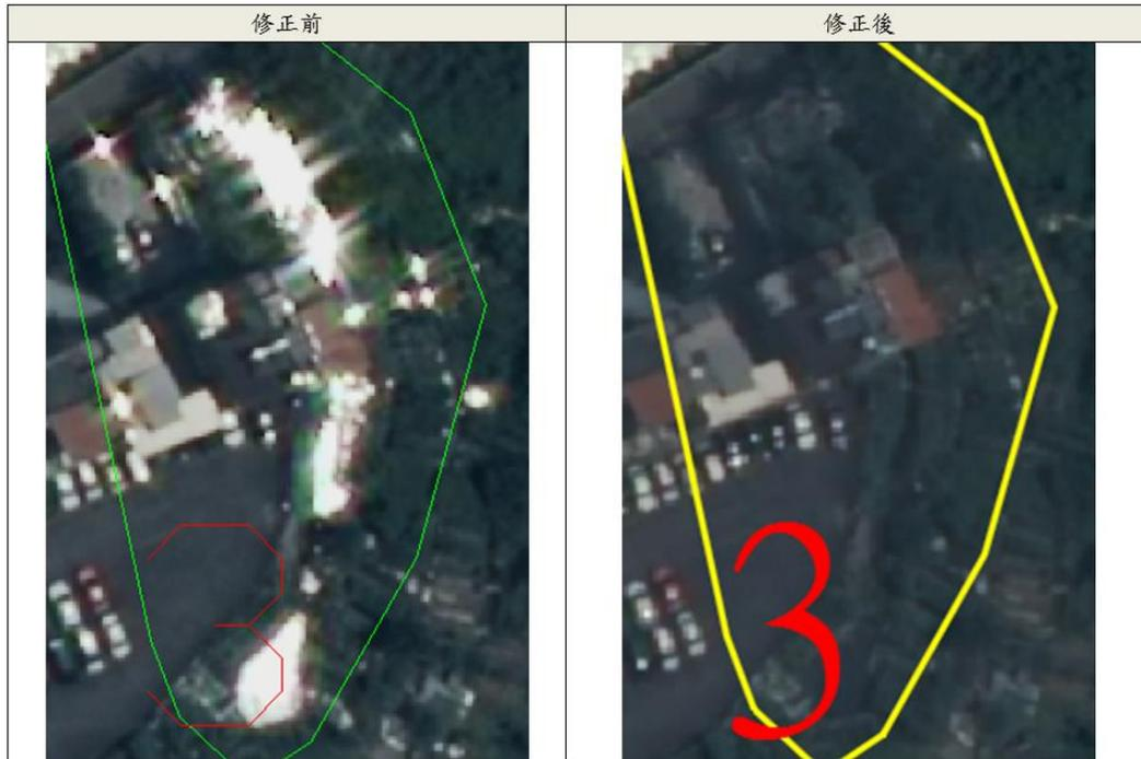
圖 4-6 正射影像曝光過度區域檢核修正
