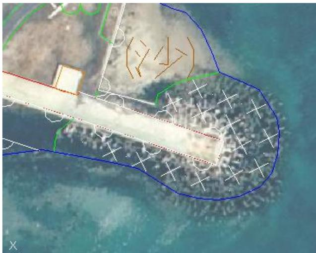
圖 3-65 消波塊的複雜線型表示
