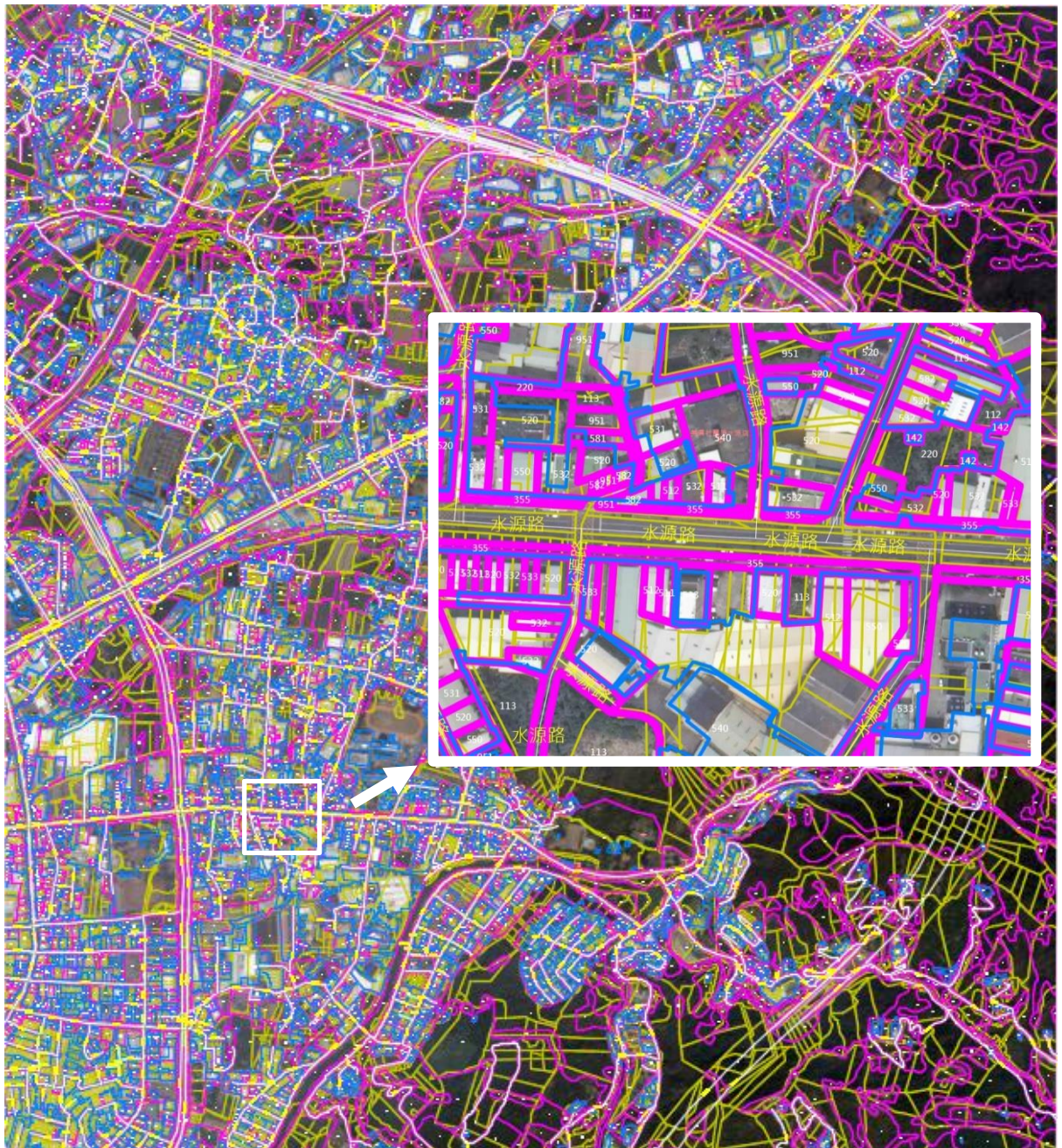
圖 2-26 外業調查圖製作示意
