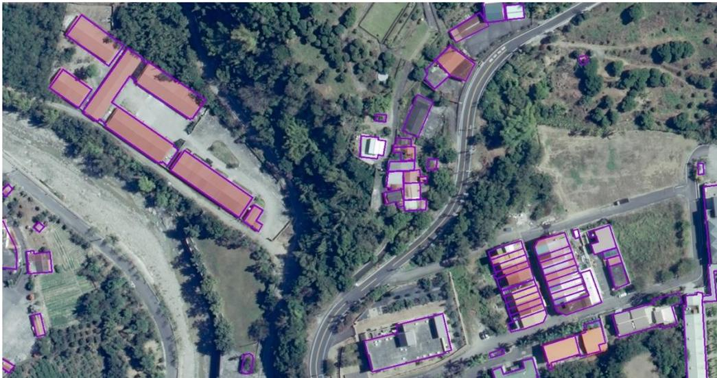
圖 3-13 建物框利用共線式逆向反推像平面坐標並與原始航拍套合分析(郊區)
