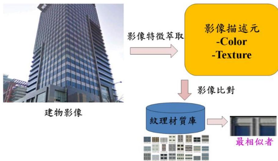
圖 2-38 材質庫影像辨識示意圖
