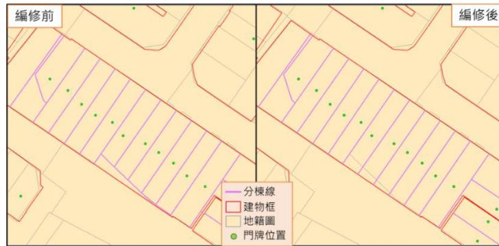
圖 2-68 分棟線延伸編修示意圖
