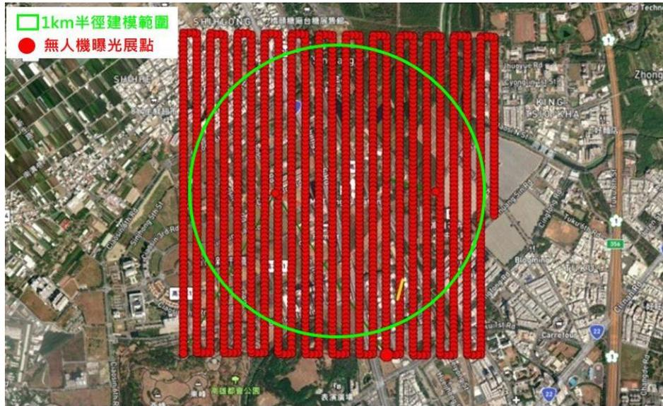
圖 3-39 3D Mesh 建模空拍航線規劃圖
