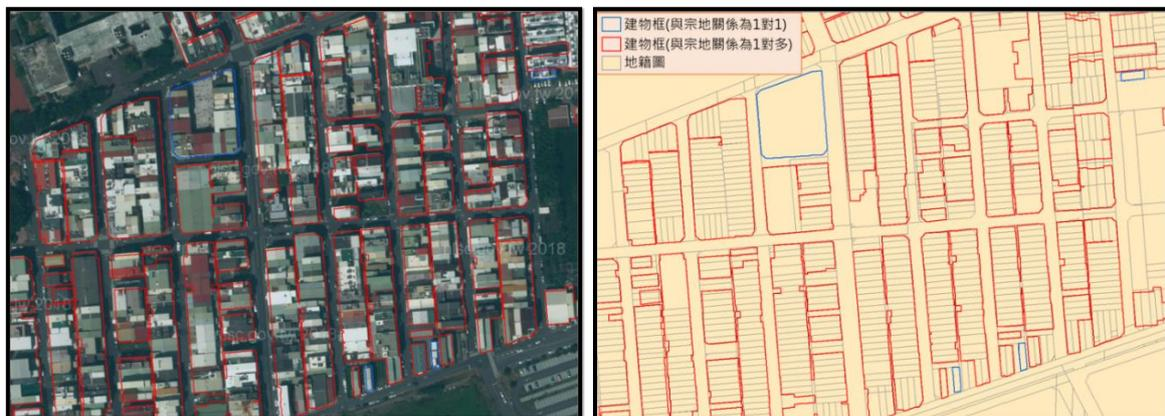
圖 2-65 建物框與地籍圖及正射影像套疊示意圖
