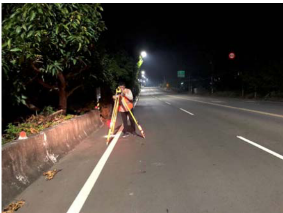
圖 3-14 三角架兩腳與水準路線方向平行
