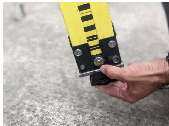
圖 3-13 上點前移除水準尺尺環
