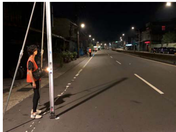
圖 3-15 儀器與二水準尺呈一直線
