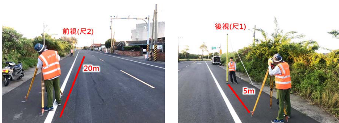
圖 3-5 水準儀視準軸校準情形
