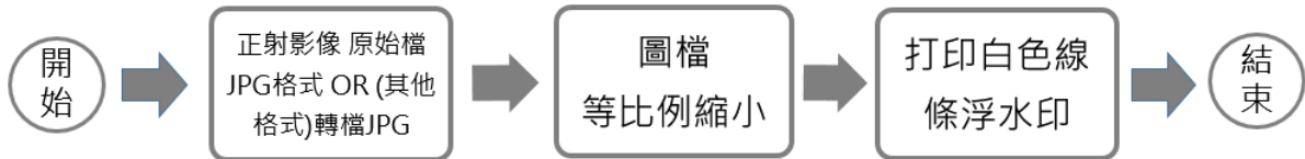
附圖 1 第一種形式縮圖製作流程圖
