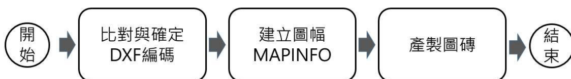
圖 6-31 五千分之一基本地形圖圖磚產製流程
