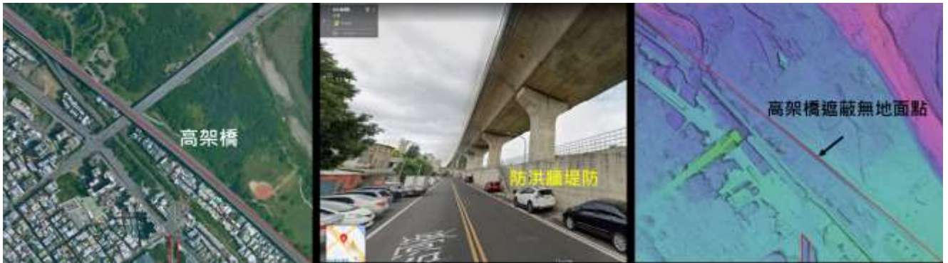
圖 5.3 受高架道路遮蔽致橋下堤防無光達地形示意圖
