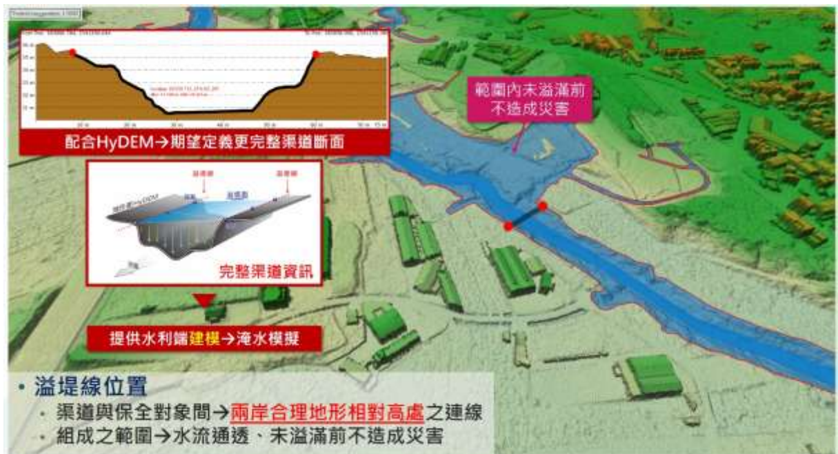
圖 3.6 溢堤線基本繪製原則示意圖(擷自 110 年教育訓練簡報)
