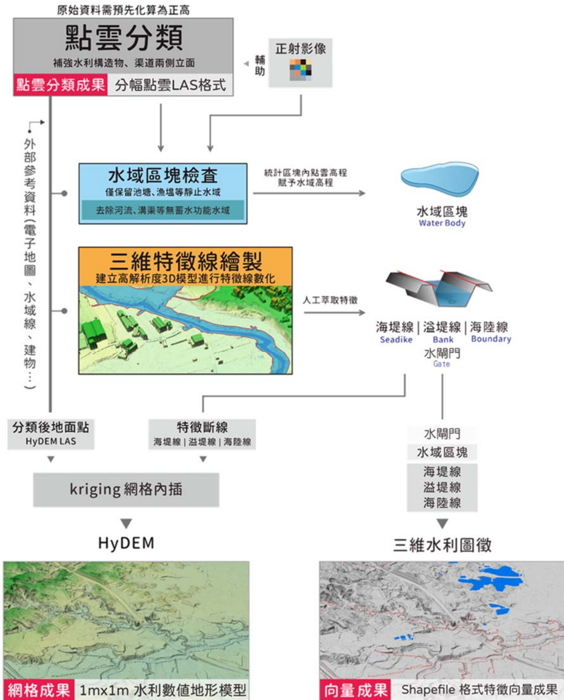
圖 2-1、水利數值地形資料集測製流程
