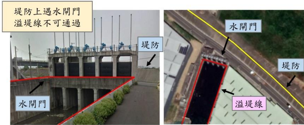
圖 3.3-11 溢堤線遇堤防之水閘門時測繪原則
