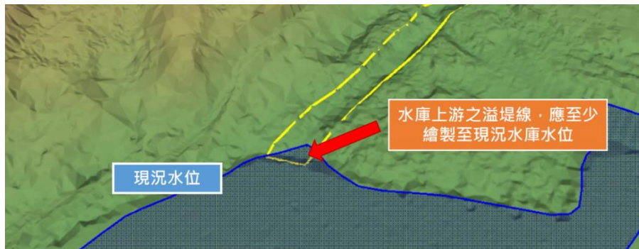
圖 3-3.12 水庫上游溢堤線繪製原則
