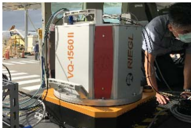
圖 4-10、光達儀器與航拍相機安裝
