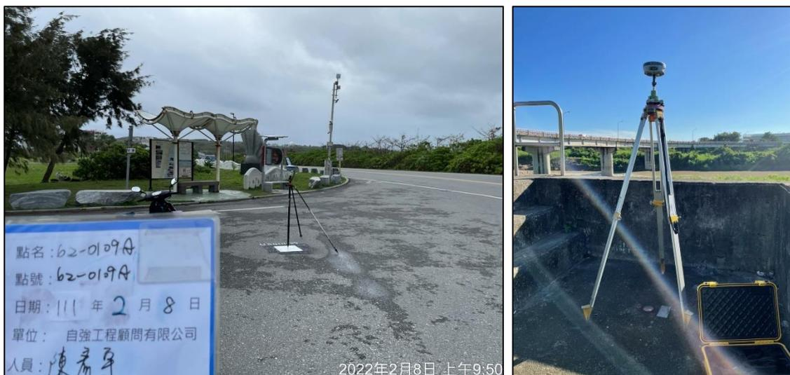
圖 2-6 地面 GNSS 衛星定位儀實際作業照
