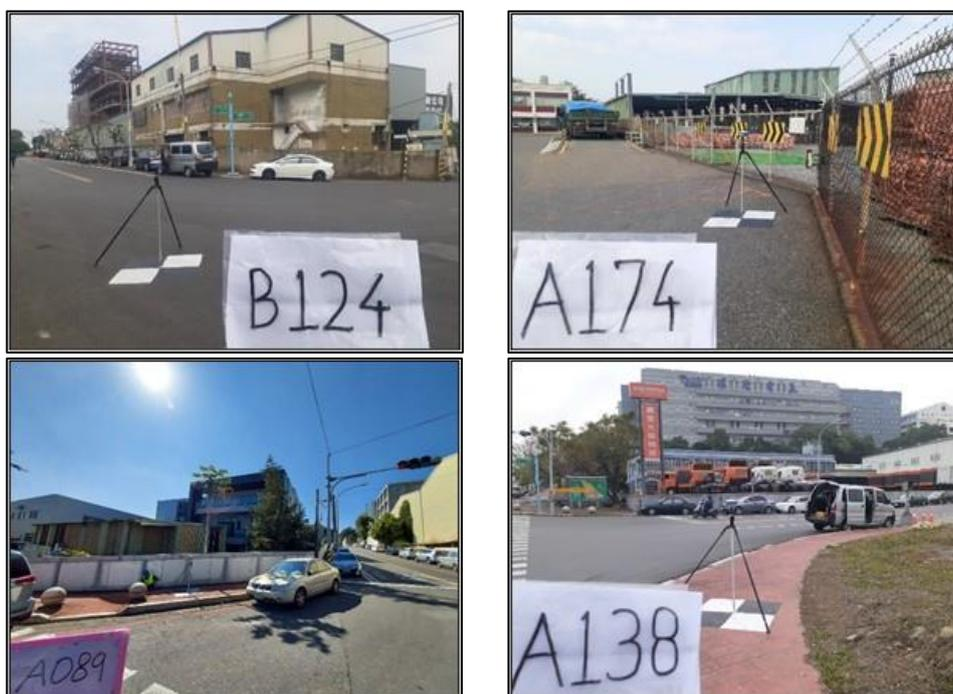
圖 2-23 南崗率定場地面高程檢核點施測作業照
