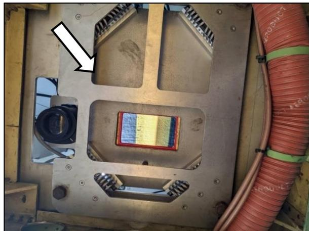
(b) 光達系統掃瞄器保護鏡面
