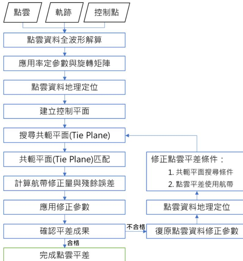
圖 2-36 點雲航帶平差作業流程
