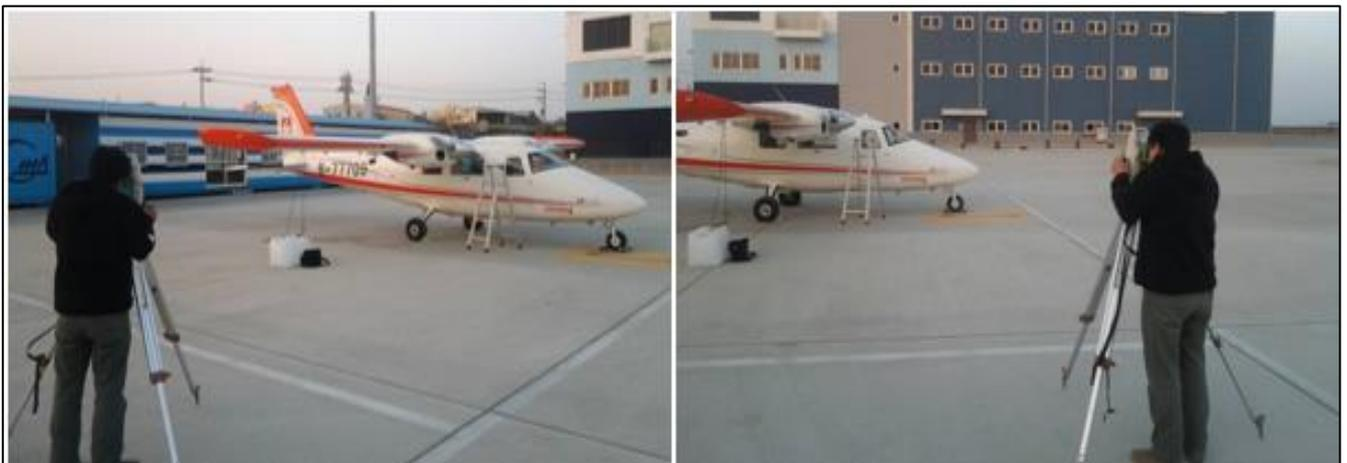
圖 2-17 Lever arm 量測作業照-P68C-TC
