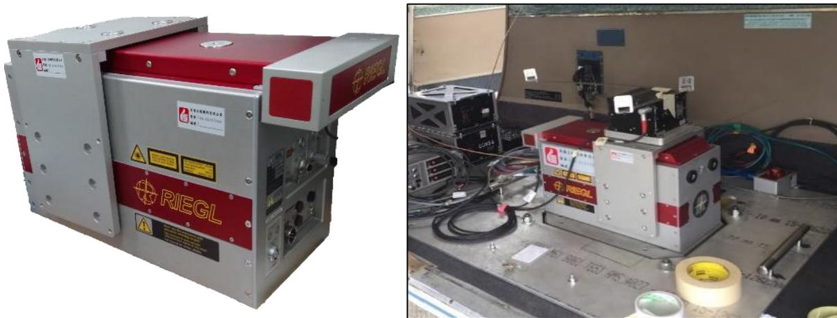
圖 2-2 空載光達掃瞄儀 Riegl LMS-Q780 (2220651)實機照
