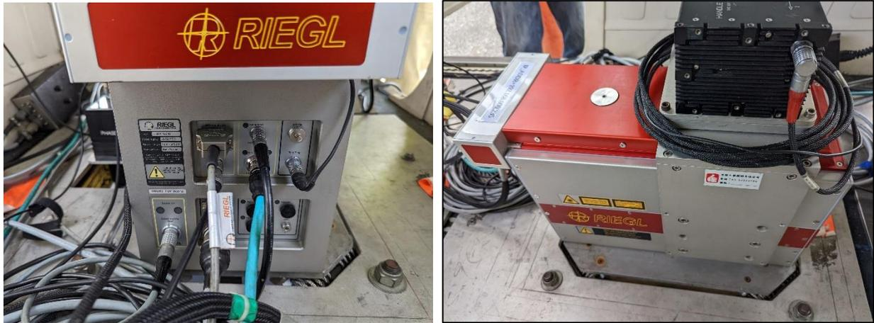
圖 2-3 空載光達掃瞄儀 Riegl LMS-Q780 (9999263)實機照
