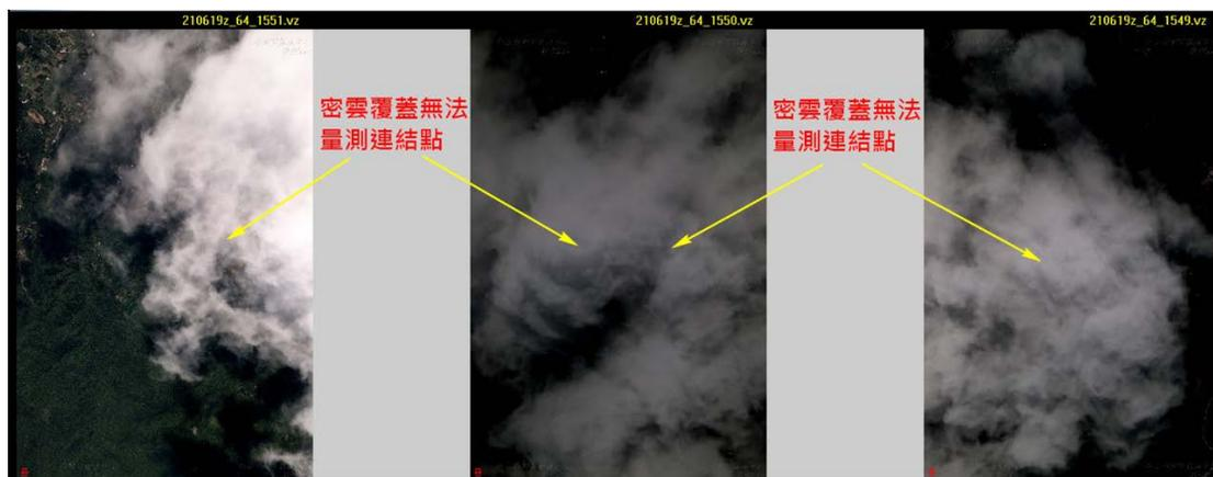
圖 2-11 雲遮蔽區造成連結點網形破洞說明圖
