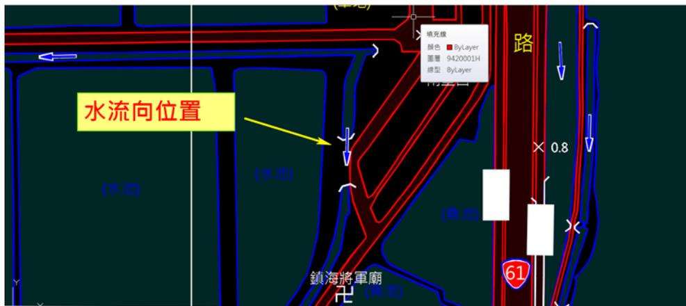
圖 3-13 出圖檔自我品管檢查(水系)範例圖
