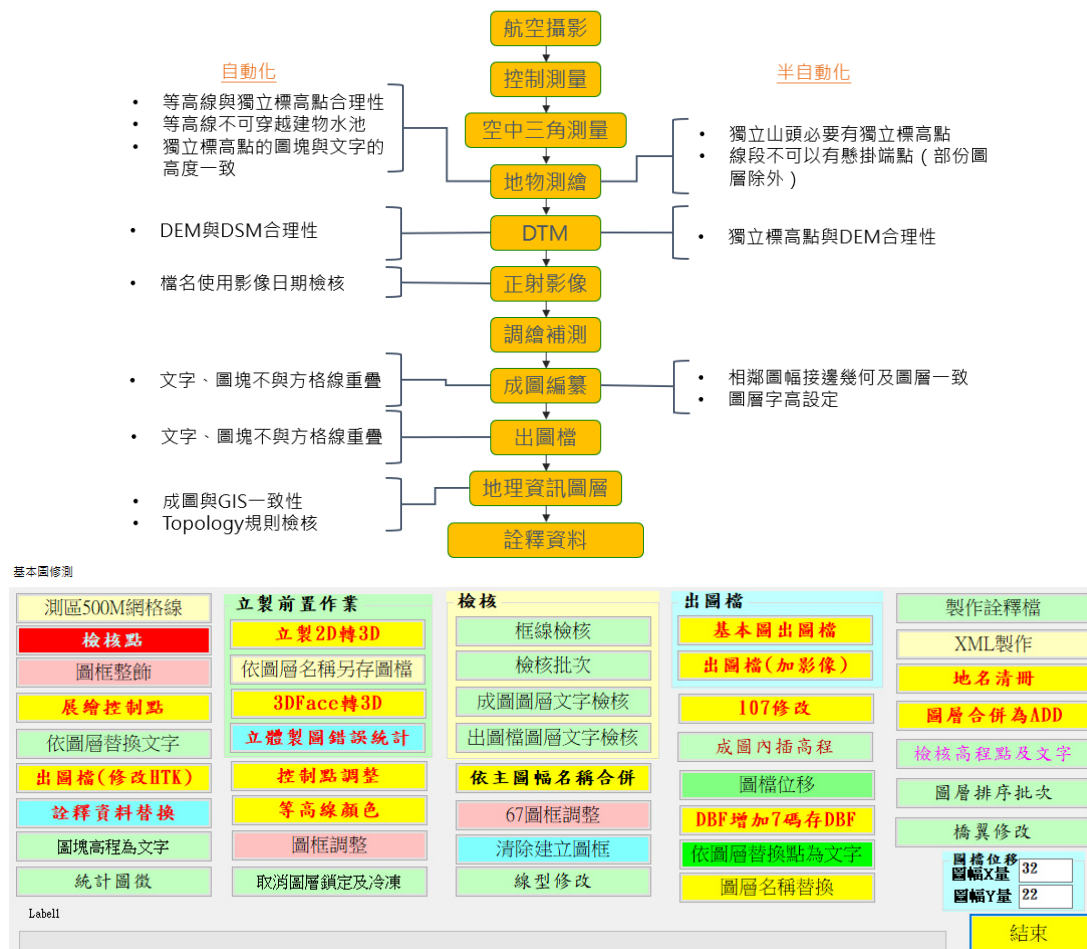
圖 4-1 自動化或半自動化的輔助檢核程式機制
