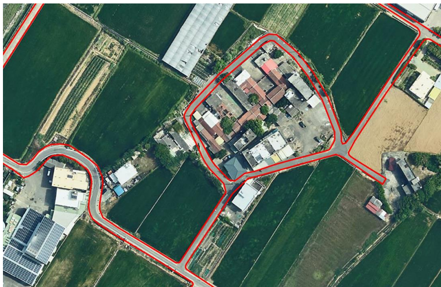
圖 3-2 光達案正射影像套疊臺灣通用電子地圖檢核
