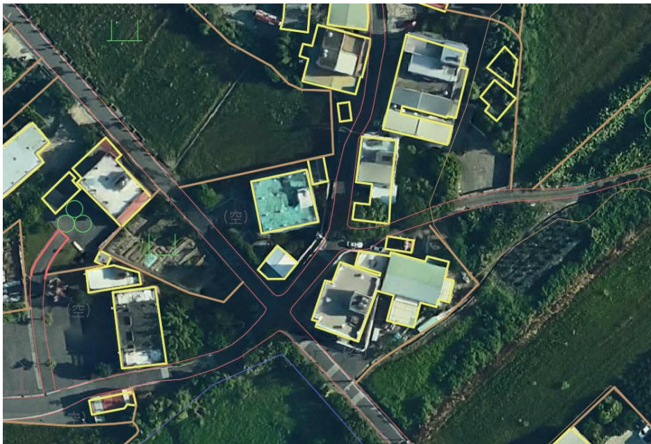
圖 4-15 建物線套疊初步真實正射影像（無明顯高差位移偏差）
