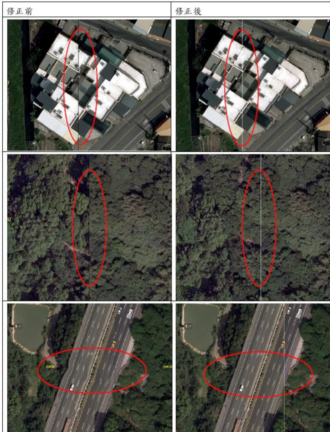
圖 4-4 正射影像接邊及變形檢核
