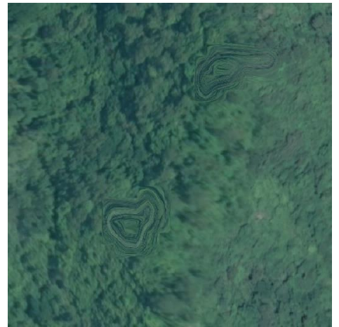
(c) DEM 缺漏造成變形
