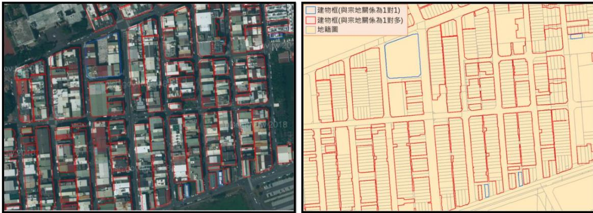
圖 3-59 建物框與地籍圖及正射影像套疊示意圖
