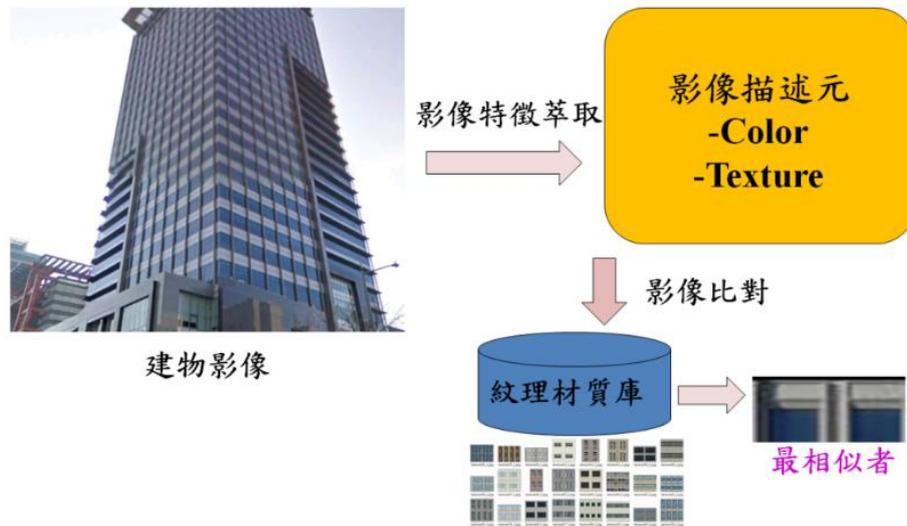
圖 3-44 材質庫影像辨識示意圖
