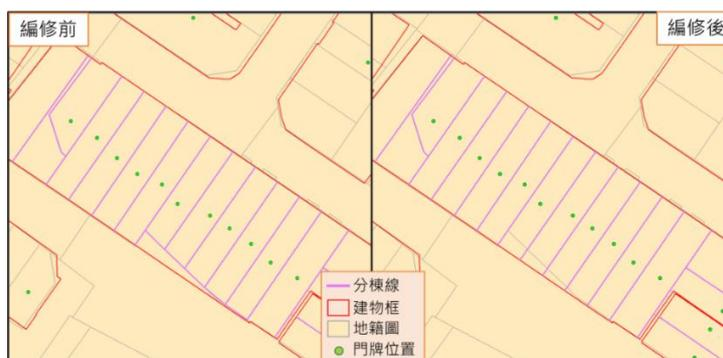
圖 3-62 分棟線延伸編修示意圖
