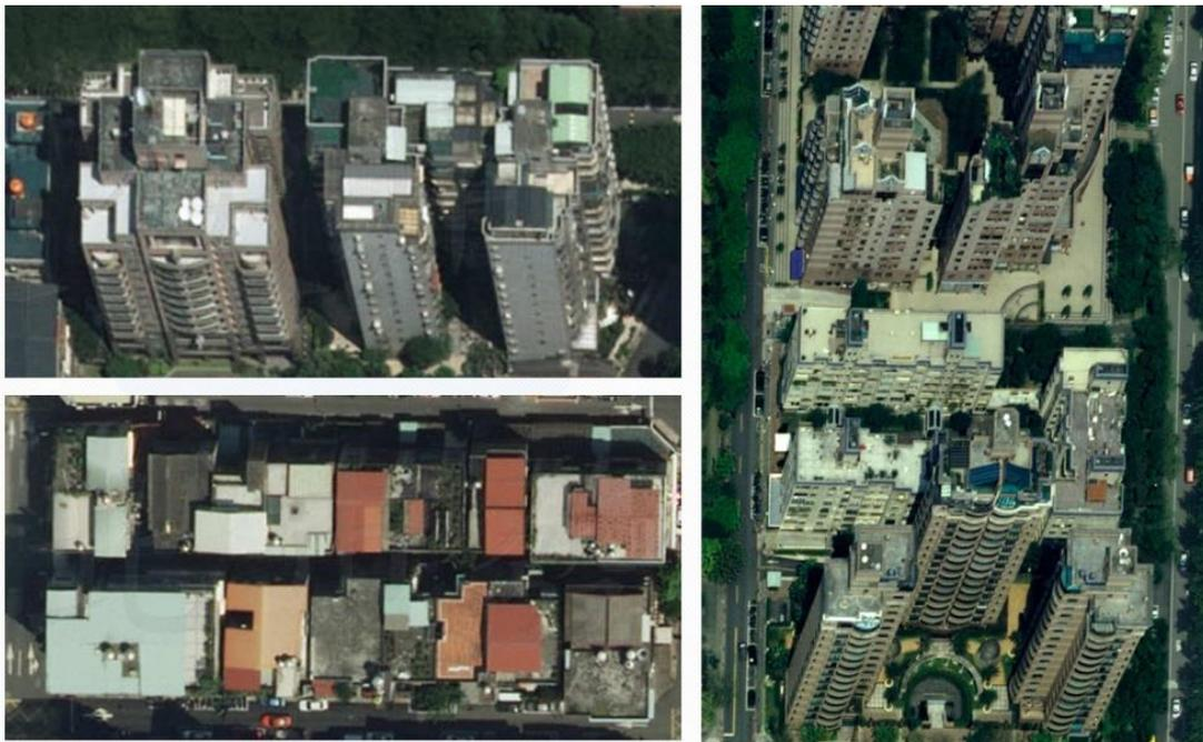
圖 3-33 正射影像建物傾斜狀況
