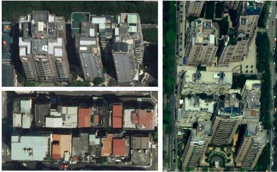
圖 2.15 正射影像建物傾斜狀況
