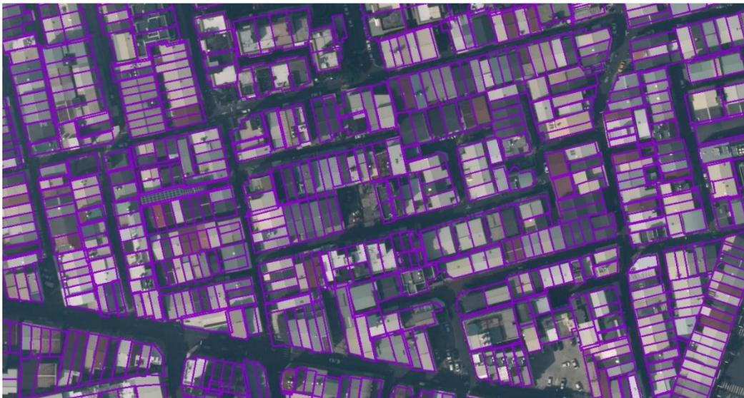
圖 4-13 建物框利用共線式逆向反推像平面坐標並與原始航拍套合分析(都會區)
