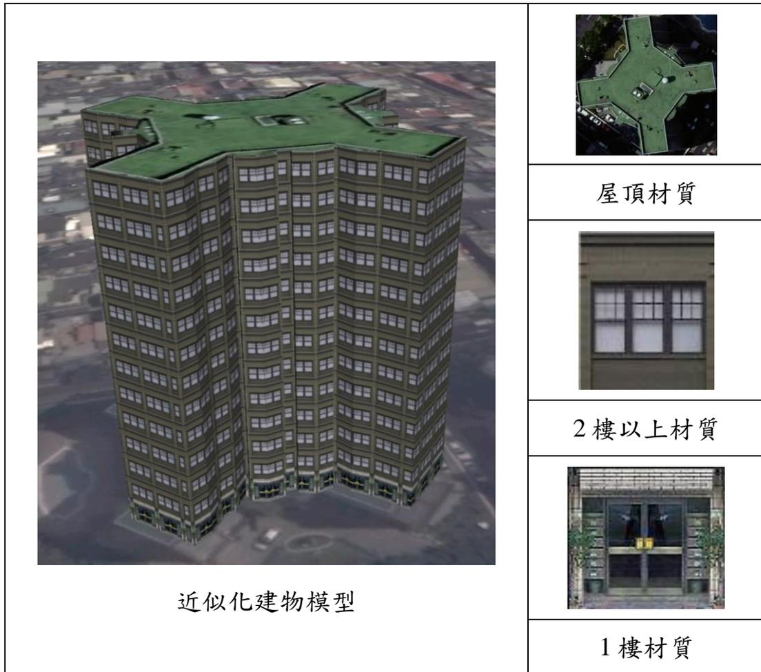
圖 3-31 近似化建物模型使用貼圖材質範例
