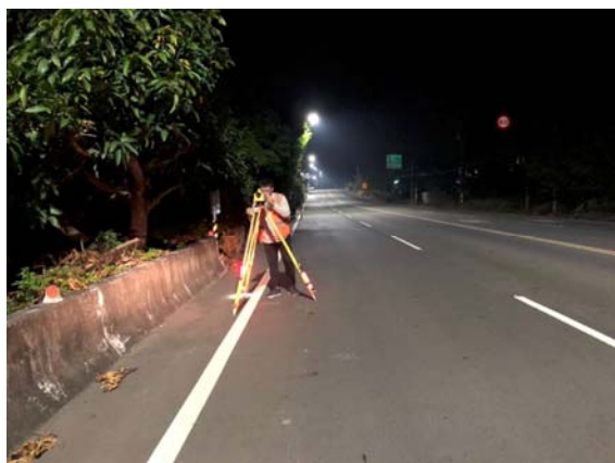
圖 3-14 三角架兩腳與水準路線方向平行
