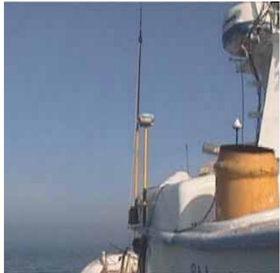
圖 7-3 海域船舶導航及海洋測量應用測試儀器整置情形
