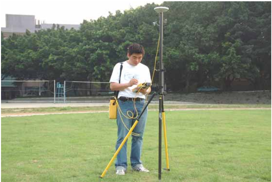
圖 5-19 VBS-RTK 定位測試相關儀器整置情形
