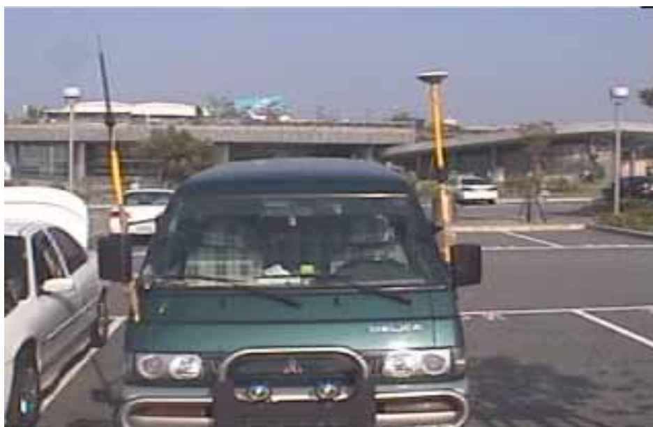
圖 7-1 陸域汽車導航定位測試儀器設備整置情形
