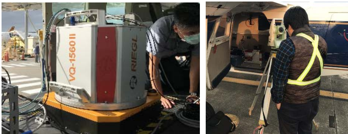
圖 4-10、光達儀器與航拍相機安裝(左:VQ1560II；右:Q780)
