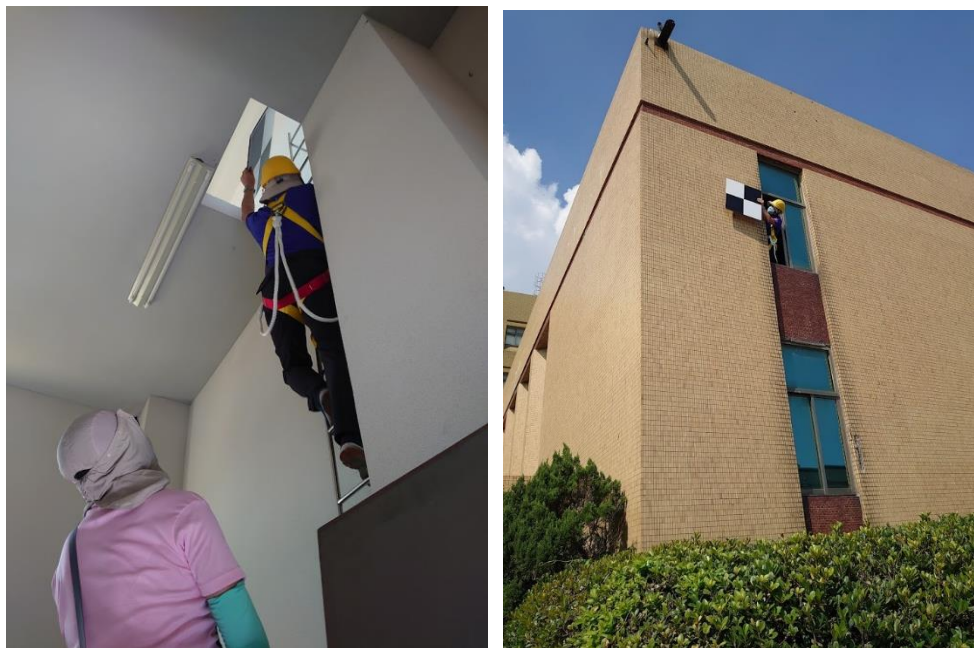
圖 6-5 安裝牆上的磁吸式校正標
