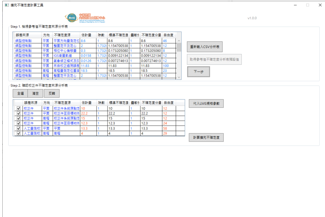
圖 3-34 擴充不確定度計算模組-預設校正件不確定度源估計量
