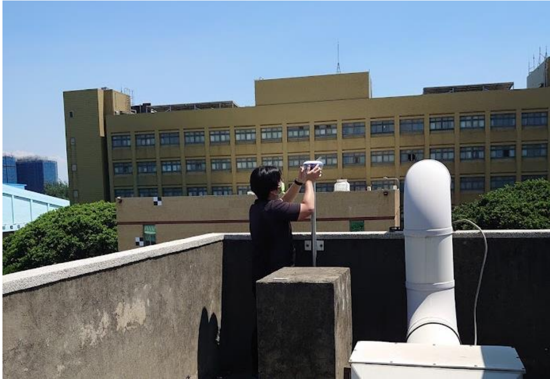
圖 6-11 GNSS 接收儀架設於基準點 A (經緯公司)
