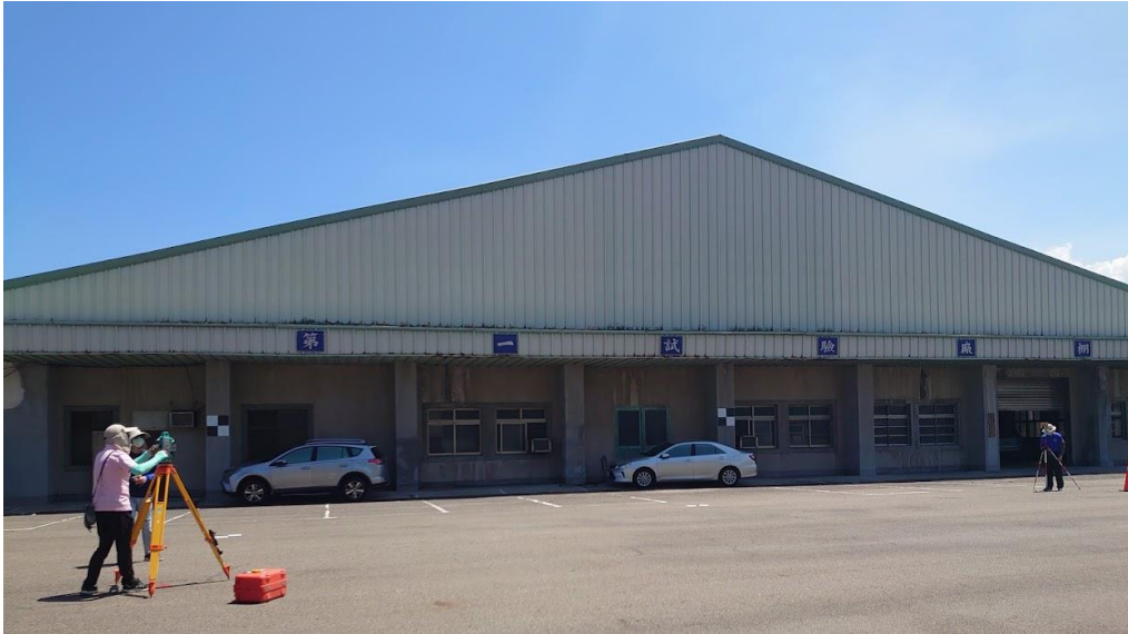
圖 6-6 校正標坐標參考值量測
