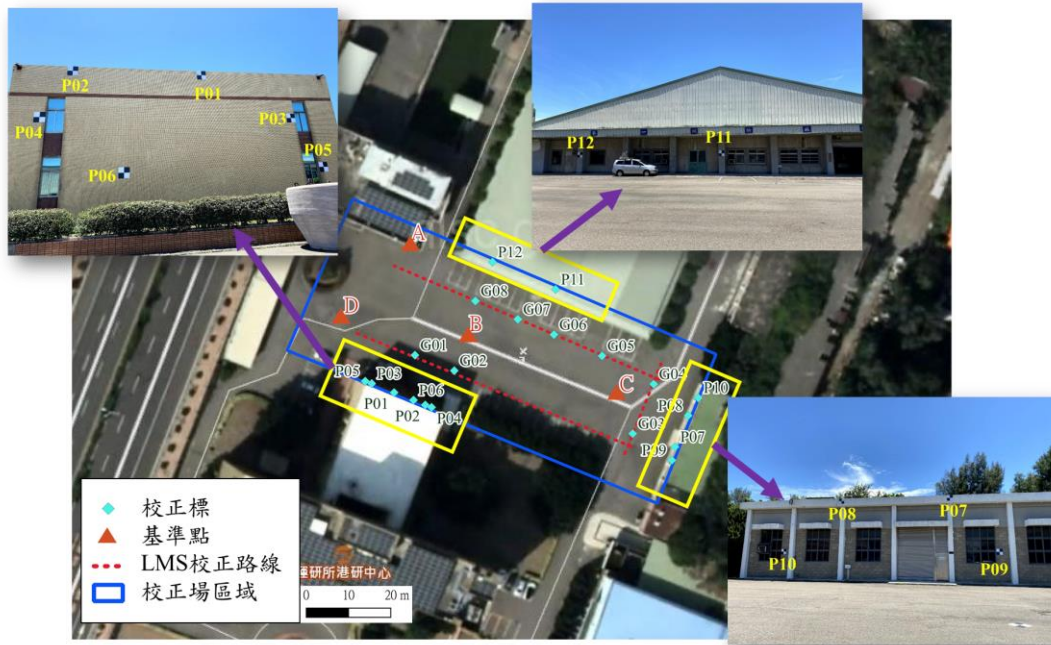
圖 2-3 校正場基準點與校正標分布示意圖
