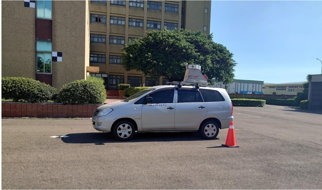
圖 6-9 光達掃描作業 1 (國土測繪中心 LMS)
