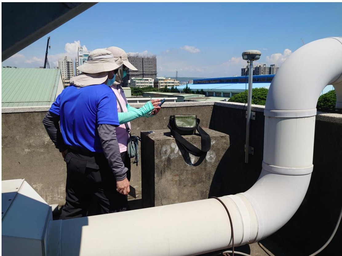
圖 6-8 GNSS 接收儀架設於基準點 A (國土測繪中心)
