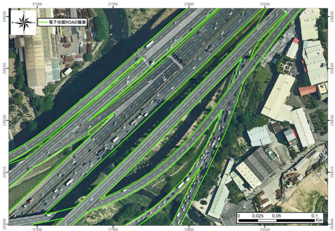
(b)高架道路高差位移糾正後
