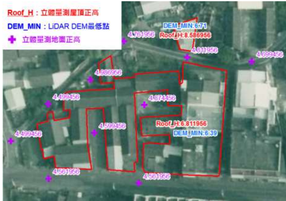
圖 4-16 以航照立體量測確認 LiDAR DEM/DSM 高程
