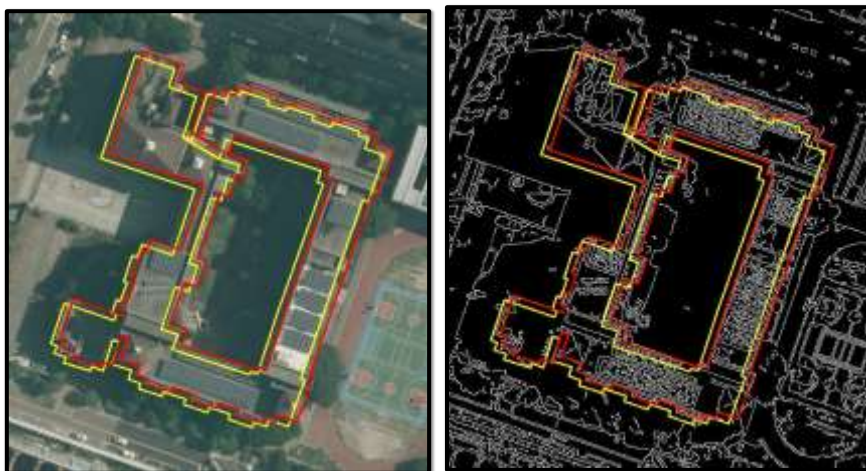
圖 3-38 影像偏移修正調整範例
