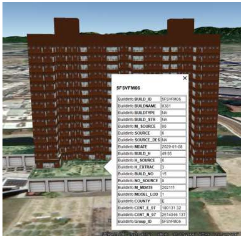
圖 3-106 三維地籍建物產權模型棟建物模型
