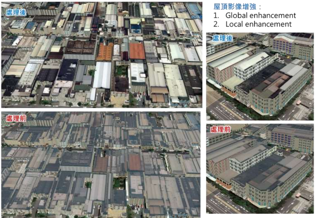
圖 3-41 屋頂影像影像增強調整前後比較範例
