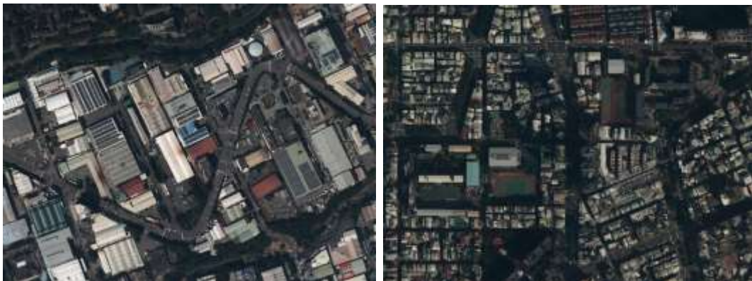
圖 2-16、正射影像建物傾斜狀況
