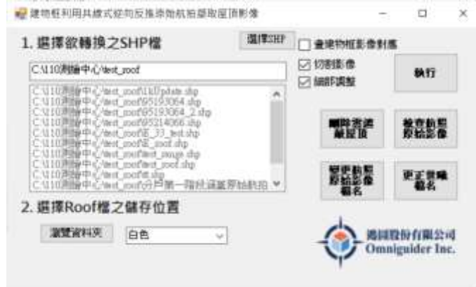
圖 4-21 建物框利用共線式逆向反推原始航拍擷取屋頂影像工具
