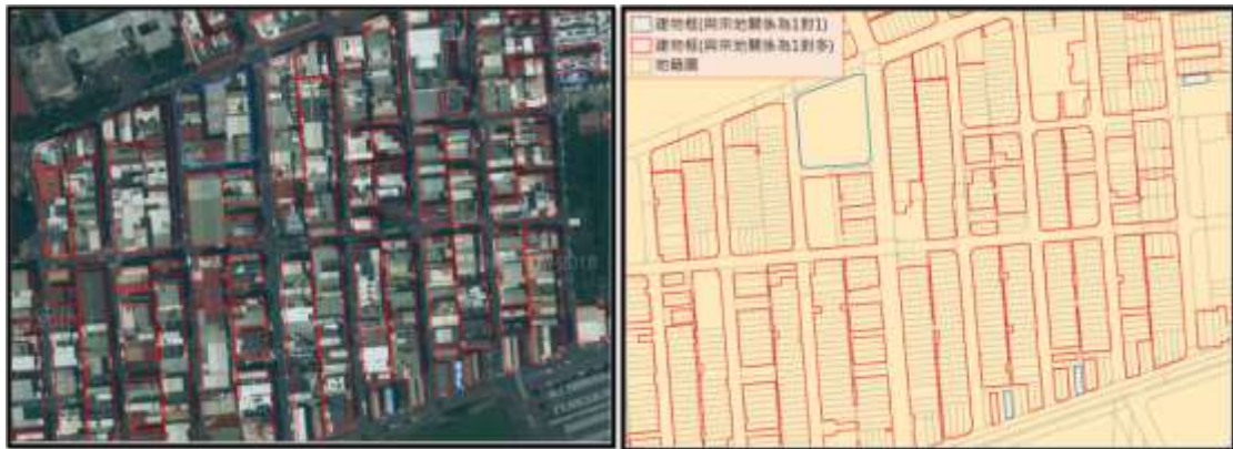
圖 3-61 建物框與地籍圖及正射影像套疊示意圖
