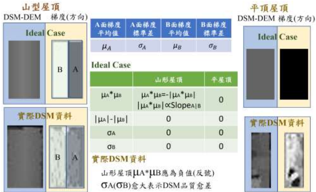
圖 2-28 利用 DSM 偵測山形屋頂之指標因子
