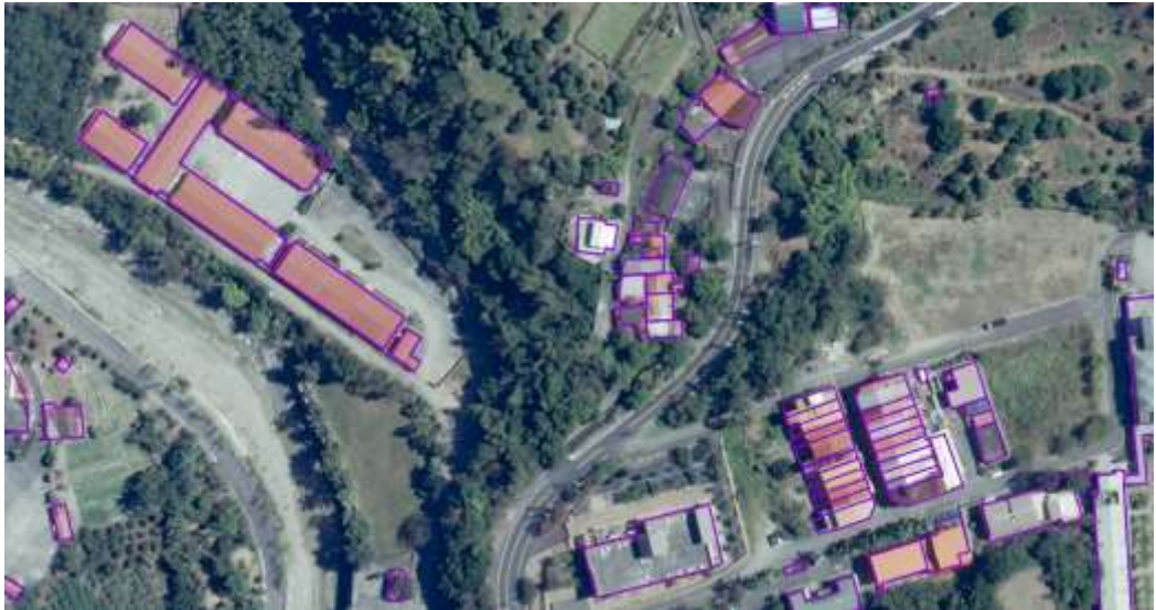
圖 4-23 建物框利用共線式逆向反推像平面坐標並與原始航拍套合分析(郊區)
