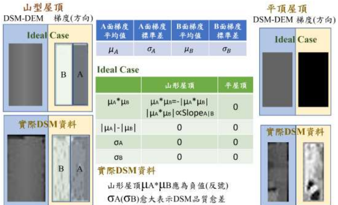
圖 3-70 DSM 偵測山形屋頂之品質驗證
