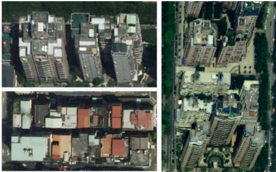
圖 2-16、正射影像建物傾斜狀況
