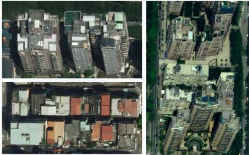
圖 3-35 正射影像建物傾斜狀況
