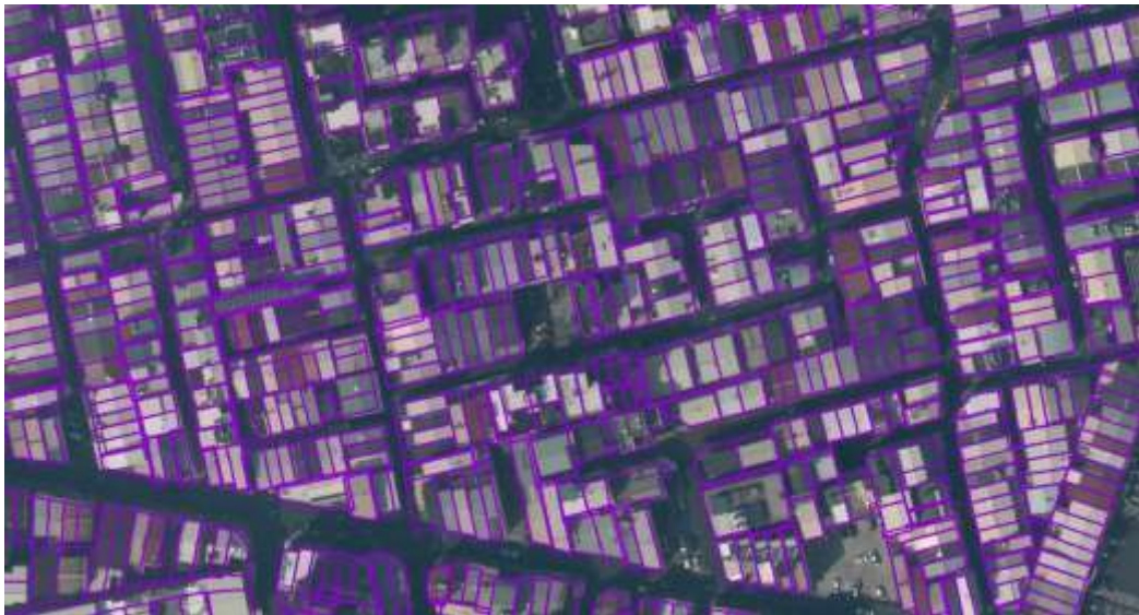
圖 4-22 建物框利用共線式逆向反推像平面坐標並與原始航拍套合分析(都會區)
